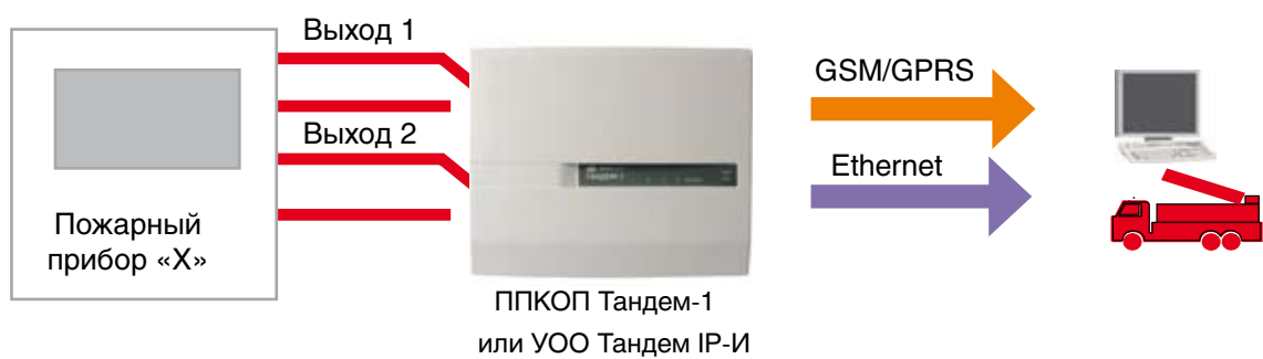
Рис.19. Пример подключения посредством релейных выходов
