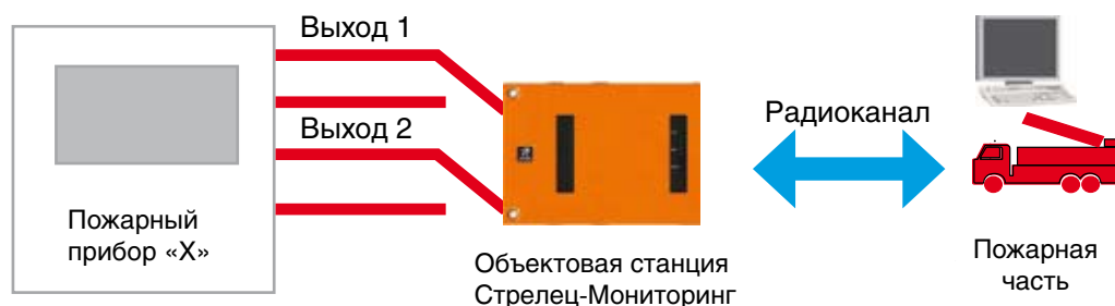
Рис.12. Пример подключения посредством релейных выходов
